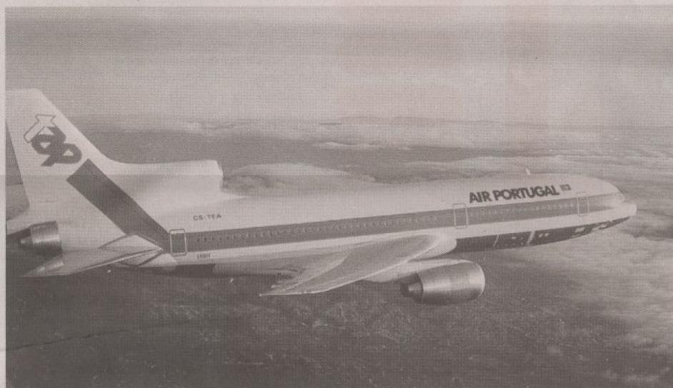
**O L1011-Lockheed TriStar esteve ao serviço da TAP de 1983 a 1997. Com uma envergadura de 50,09 metros e 50,05 metros de comprimento, atinge a velocidade de 900 km/hora e transporta 248 passageiros.**
